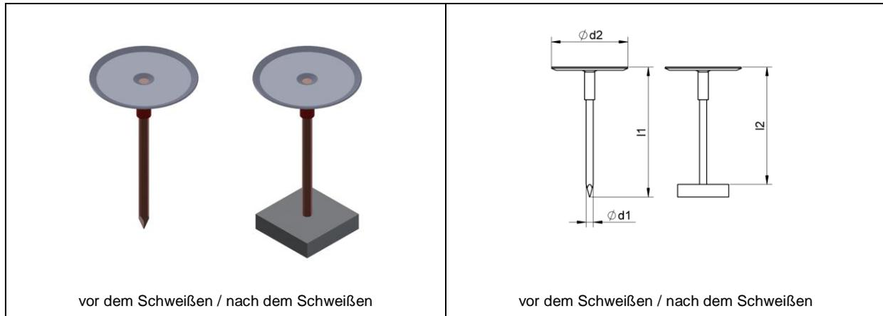
Der Schaft des Tellerstifts ist isoliert. Isolierte Tellerstifte werden zur Befestigung von Isoliermatten mit Aluminiumkaschierung bzw. Drahtnetz verwendet. In Verbindung mit dem Niederhalter der Bolzenschweißpistole verhindert die Isolierung, dass während des Schweißens ein Kurzschluß mit der Aluminiumkaschierung bzw. dem Drahtnetz auftritt.
